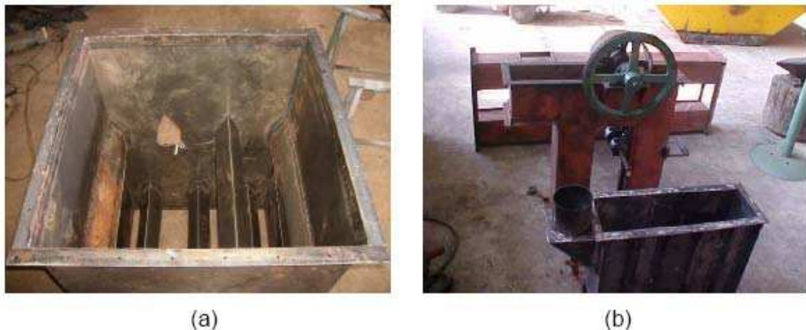
FIGURA 08. Detalhes das calhas internas do secador (a) e da construção do elevador de caçambas (b).
