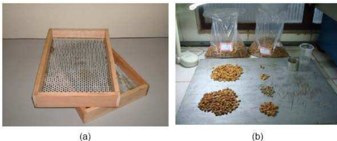
FIGURA 17. Peneiras utilizadas para a determinação do índice de impureza (a); avaliação de danos no pergaminho na massa de grãos (b).
