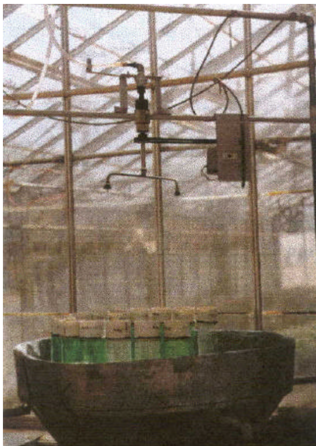
Figura 6 - Simulação de chuva para o estudo da percolação do triadimenol.
