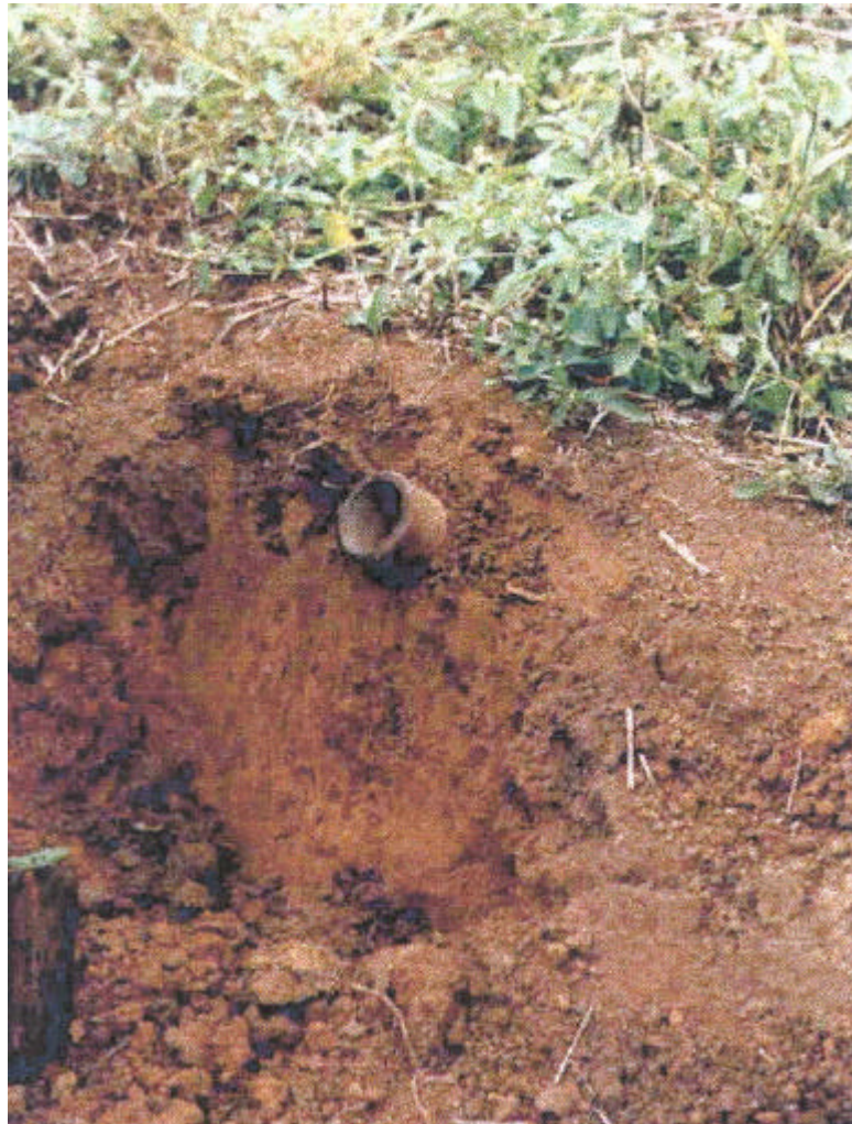
Figura 1A - Introdução do anel de metal, no perfil de um dos solos utilizados, para a determinação da densidade.
