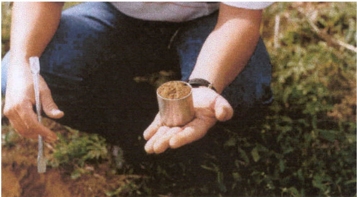
Figura 2A - Detalhe do anel de metal após a retirada do mesmo do perfil do solo.
