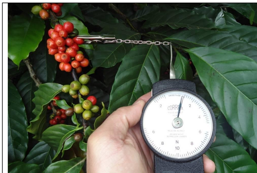
Figura 1- Medição da força de desprendimento de frutos cereja de conillon, vendo-se o equipamento e o detalhe de como é preso e puxado o fruto.
