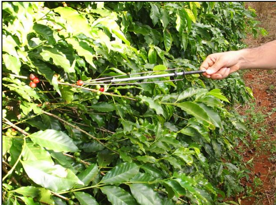
FIGURA 01 Dinamômetro portátil em operação de campo.
