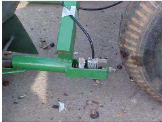
FIGURA 3 - Célula de carga para medição do esforço de revolvimento
