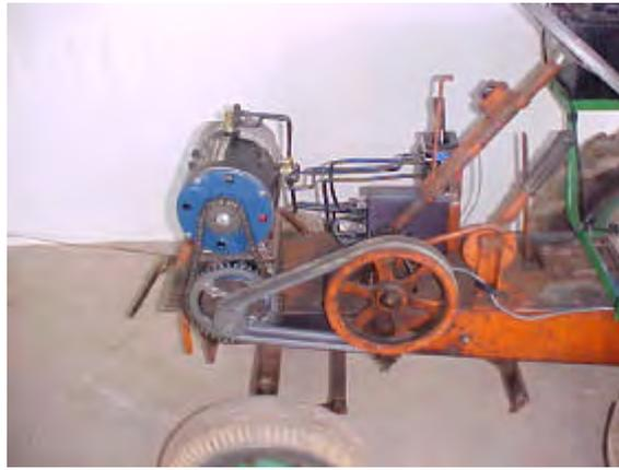
FIGURA 5 - Motor elétrico CC instalado no microtrator MCC.
