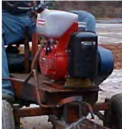
FIGURA 8 - Motor ciclo Otto instalado no microtrator MCI
