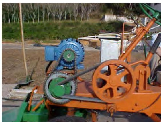
FIGURA 3 - Motor elétrico CA instalado no microtrator MCA.
