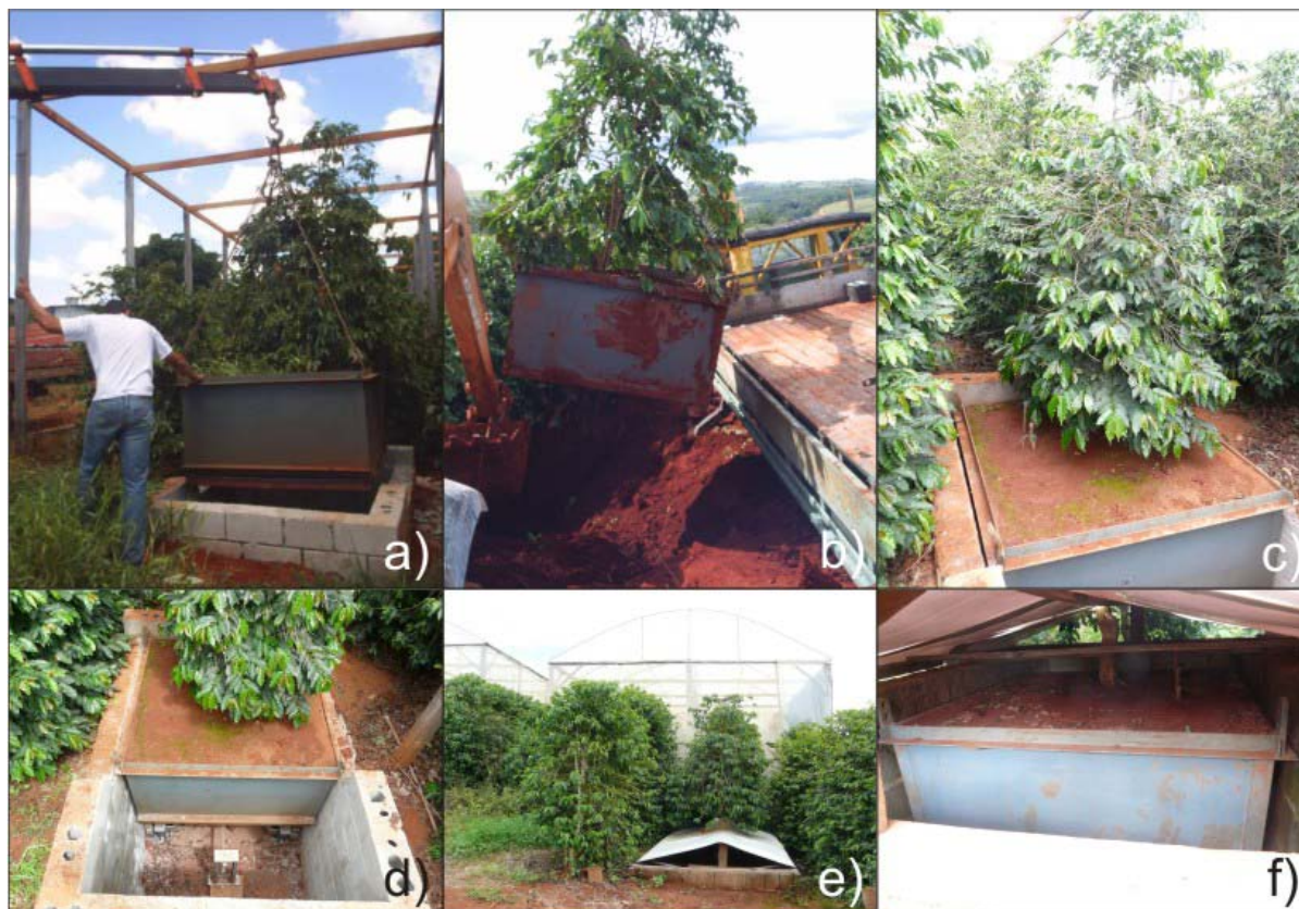
Figura 1. As imagens (a) e (b) ilustram o processo de construção dos lisímetros; o lisímetro de dentro da estufa está apresentado em (c) e (d); e o lisímetro de fora do ambiente protegido em (e) e (f).
