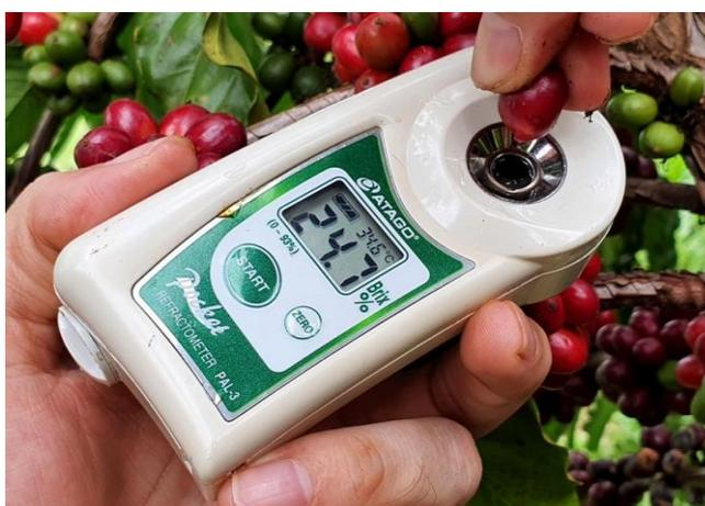
**Figura 6.** Refratômetro digital.
