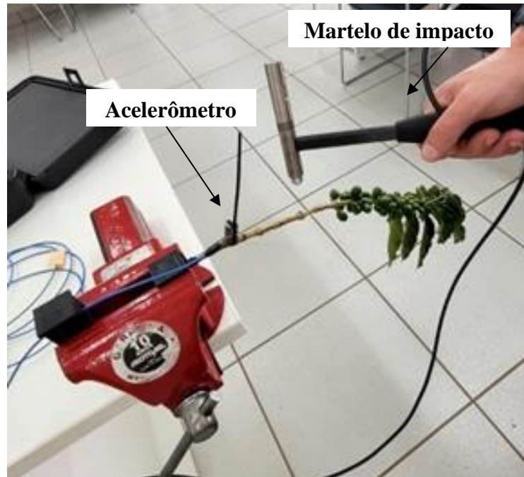
Fig. 6 - Configuração de coleta de dados. O acelerômetro está encaixado no meio do ramo e a vibração é feita com o martelo de impacto.
