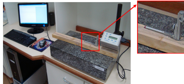
Figura 3 – Análise da rugosidade realizada por um rugosímetro de arraste.
