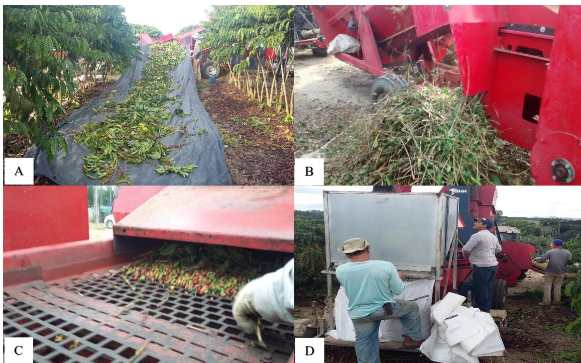
Figura 6 - Entrada do material na recolhedora (A), saída das impurezas mais grossas (B), peneiras vibratórias para separar os grãos de café das impurezas mais leves (C) e ensacamento dos grãos (D).
