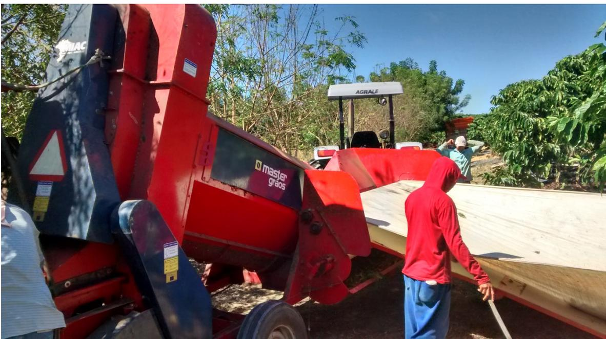
Figura 3 - Recolhedora Master Grãos CR em funcionamento, acoplada ao trator Agrale.
