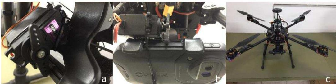
Figura 3. Estrutura do disparador e fixação do sistema no VANT: a) posição do servo motor; b) Fixação na câmera para disparo; c) conexão com o VANT.
