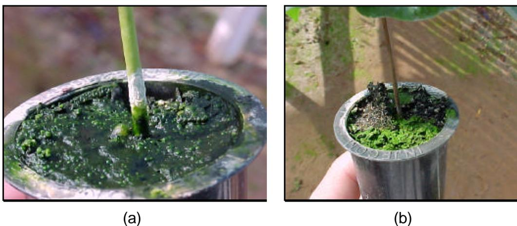
Figura 11 - Selamento superficial devido ao desenvolvimento de algas. Fase inicial com aspecto pastoso (a) e película seca e impermeável à infiltração de água (b).
