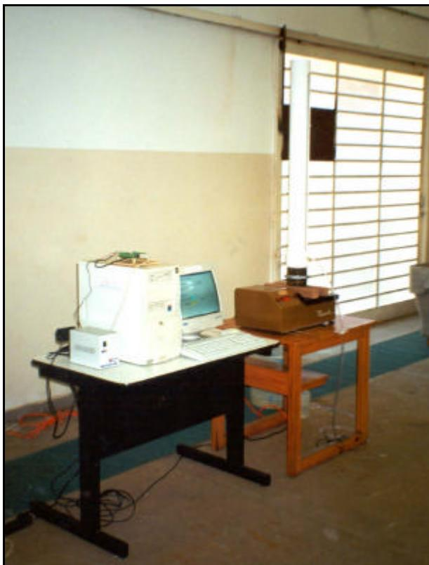
Figura A4 - Ensaio de laboratório para a obtenção da equação de calibração do sensor.
