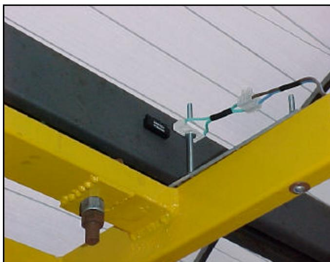
Figura B7 - Detalhe do sensor de posição e do ímã responsável pelo fechamento do circuito.
