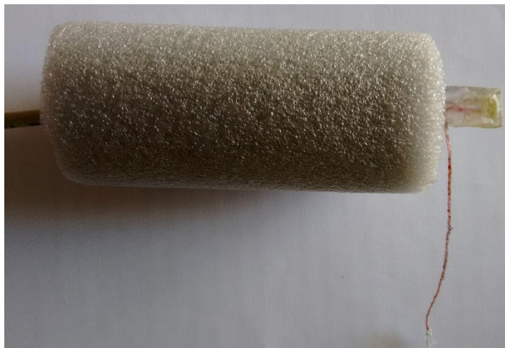
Figura 5. Sensor de fluxo de seiva finalizado, caracterizando o material isolante protegendo a placa acrílica de agentes externos, e os fios aquecedor e o conjunto termopar, envoltos pelo fio de cobre esmaltado.
